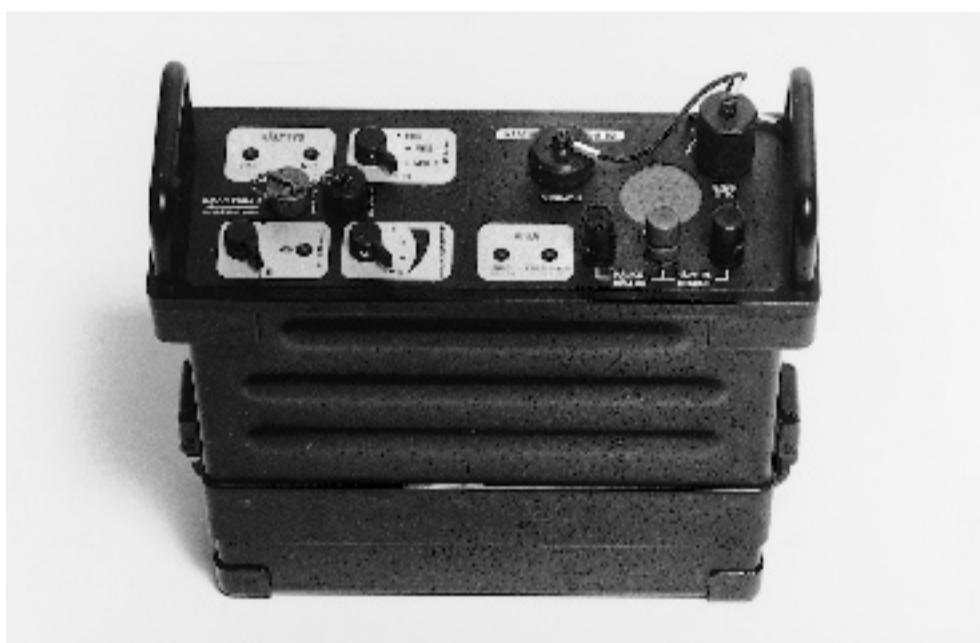
Kemiallisen aseiden valvontaan kehitetty detektorin tulee havaita varsinaiset taistelukaasut äärimmäisen pienissäkin pitoisuuksissa, mutta toisaalta ne eivät saa antaa väärää hälytystä muista ilman epäpuhtauksista, kuten pölystä, sumusta ja auton pakokaasuista. Tämä ongelma on onnistuneesti ratkaistu M86/A-D1 detektorissa, jonka Puumalaisen tutkimuslaitos ja Puolustusvoimien tutkimuskeskus yhdessä kehittivät MATINEn rahoituksella käynnistetyssä tuotekehitysprojektissa. – SA-kuva.
