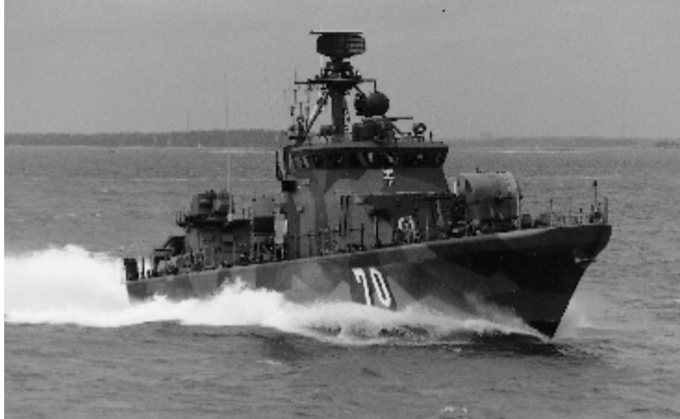
MATINEn projektissa kehitettyjä, tutkasäteitä absorboivia materiaaleja on käytetty merivoimien Helsinki- ja Rauma-luokan ohjusveneiden rakenteissa. – SA-kuva.
