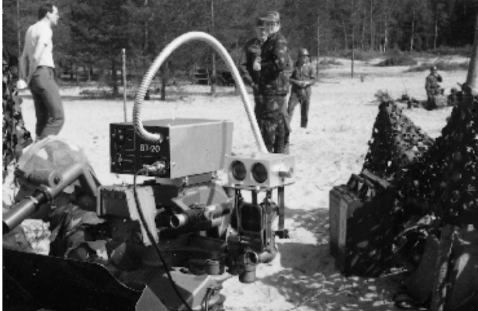
Ilmatorjunnan suuntaajan harjoittelulaitteen prototyypin kehittämiseksi antoivat sysäyksen 1970-luvun lopun laser-sovellutustutkimukset, joita MATINE oli myös osaltaan tukenut. It-kanuunan yhteydessä käytettävän laitteen tekniikka perustuu puolijohdelaseriin, joka lähettää tykille ominaisella tulinopeudella valopulseja tähtäimen osoittamaan suuntaan. Laserpulsin takaisinheijastuminen valoa heijastavasta maalista rekisteröityy vastaanottimessa osuena. Kuvassa harjoittelulaitteen elektronikkaosa (vas.) ja lähetin-vastaanotin (oik.). – Kuva MATINEN tutkimusraportti nro 129.
