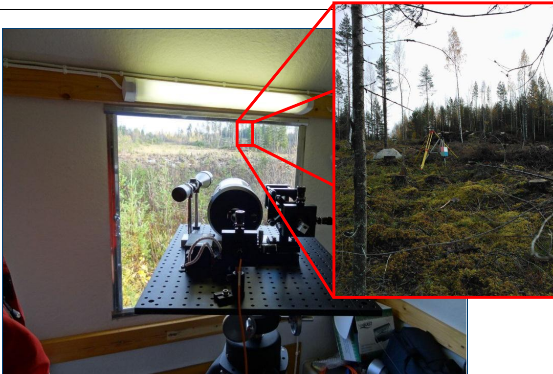
Kuva 4. Kenttätestit 250 m etäisyydeltä. Laitteisto oli sijoitettuna katettuun perävaunuun. Mitattavat kohtiot näkyvät oikeanpuoleisessa kuvassa.
