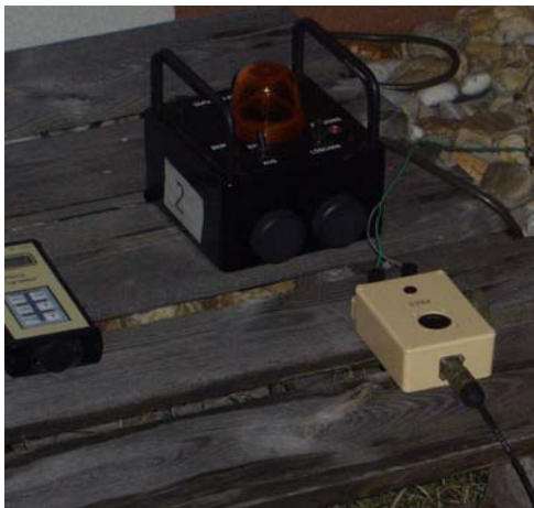
KUVA 13. PAIS-laukaisujärjestelmä. (kuva: SALAKKA-projektiryhmä)
