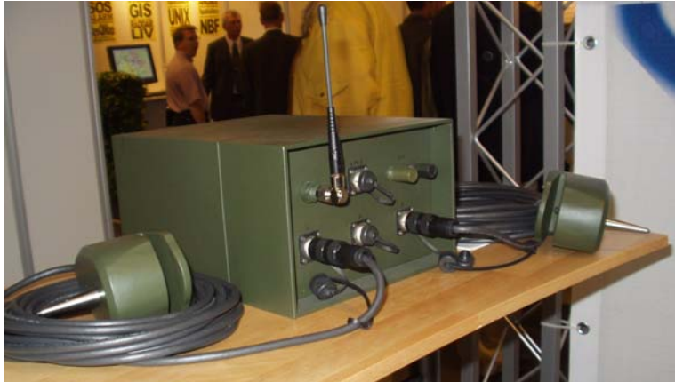
KUVA 12. UMRA-sensoryksikkö kaapeleineen. (kuva: SALAKKA-projektiryhmä)
