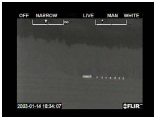
KUVA 15. Ryhmä ja telakuorma-auto, etäisyys 6000 m (ThermoVision 2000). (kuva: SALAKKA-projektiryhmä)
