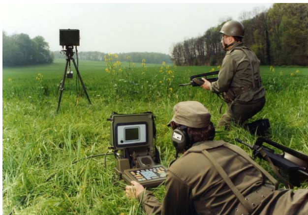
KUVA 18. RB-12B maavalvontatutka (valmistaja Thales Air Defence). (Kuva: Jane's Information Group)
