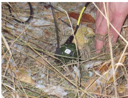
KUVA 8. MIS akustinen sensori. (kuva: SALAKKA-projektiryhmä)
