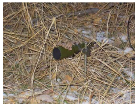
KUVA 9. MIS infrapunasensori. (kuva: SALAKKA-projektiryhmä)
