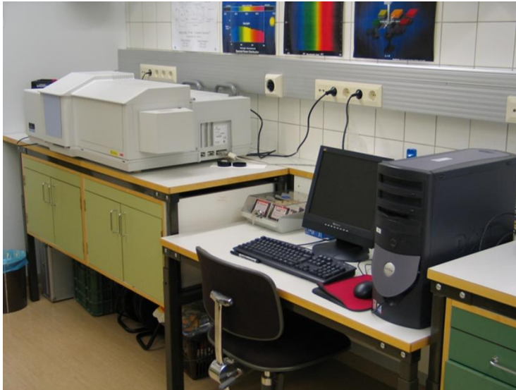
Kuva 2. PVTT:llä käytössä oleva UV-VIS-NIR-spektrofotometri Perkin Elmer Lambda 900.
